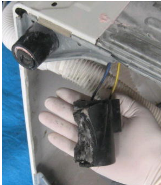
電気洗濯機のコンデンサによる事故
