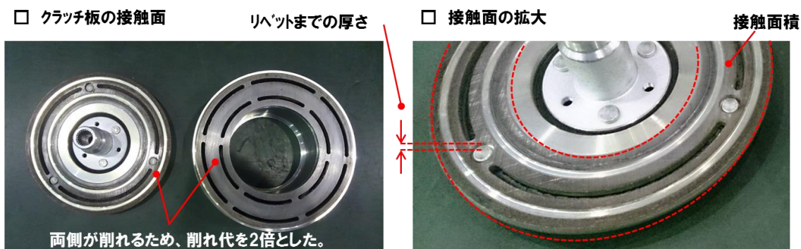
図 3.2.1.1.4 クラッチの分解写真
