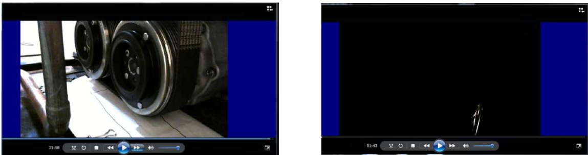
図 3.2.2.1.1 クラッチ火花を撮影した画像（同じ角度から発生前と発生時の画像）
